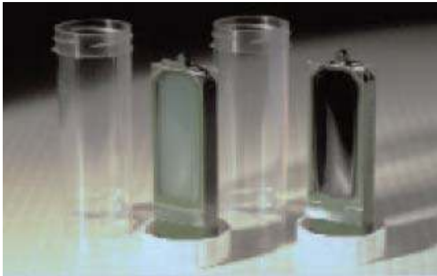
Resim 3b. 'CRT bacteria' kiti içerisinde yer alan agar yüzeyler, agar taşıyıcı ve test tüpü.
