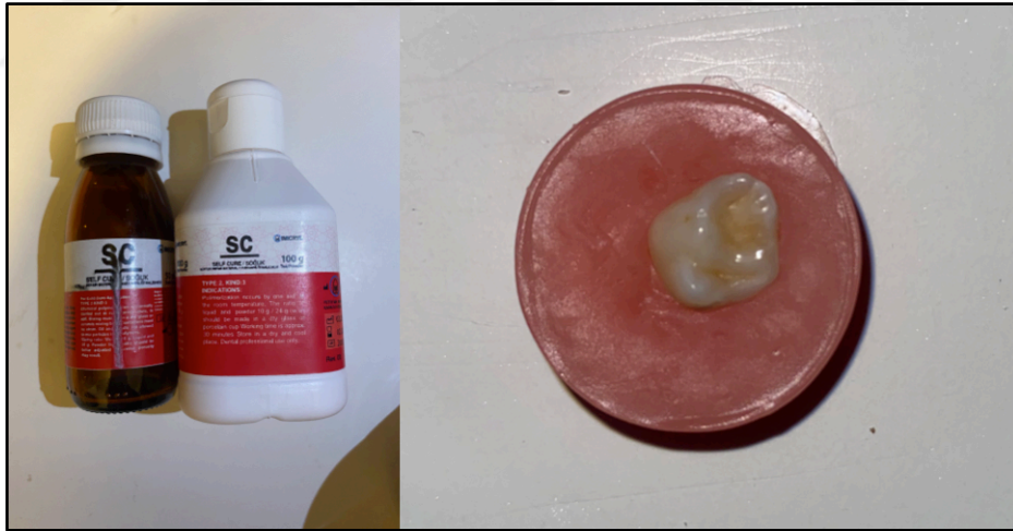
Şekil 3-2: Dişlerin akriliğe gömülmesi.
