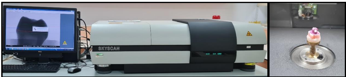
Şekil 3.18. SkyScan 1172 (Kontich, Belgium) Mikro-BT cihazı
