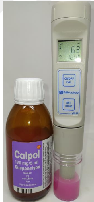
Şekil 3-3: pH metre ile ilaçların pH ölçümleri
