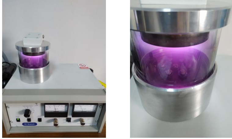
Şekil 3-9: Hazırlanan örneklerin SEM görüntülenmesi için vakum cihazında altınla kaplanması
