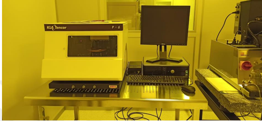
Şekil 3-8: Örneklerin yüzey pürüzlülüğü analizi yapılan mekanik profilometre cihazı
