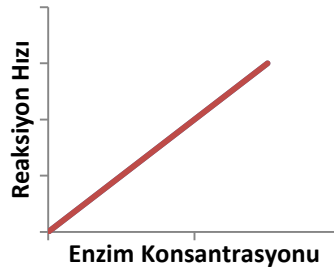
Şekil 2.8. Enzim konsantrasyonunun enzimatik reaksiyon hızına etkisi
