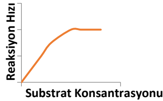
Şekil 2.9. Substrat konsantrasyonunun enzimatik reaksiyon hızına etkisi
