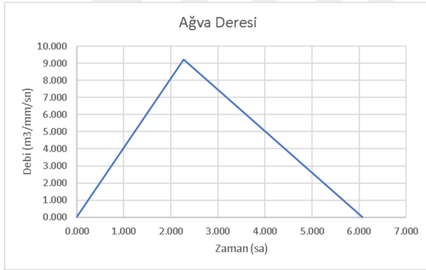
Şekil 3.36. Ağva Deresi Mockus yöntemi ile oluşturulan birim hidrograf
