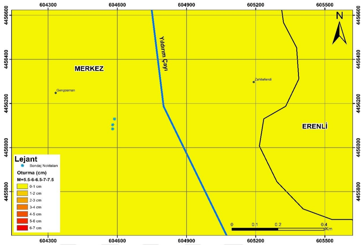
Şekil 119. Bayburt stadı batı tribününe ait büyüklüğü 5,5-6-6,5-7,0-7,5 olan deprem senaryosunun oturma potansiyeli haritası.
