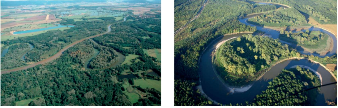
Şekil 1.14. a) Yeniden mendereslendirmeden önce b)Yeniden mendereslendirmeden sonra (Anonim, 2022c)
