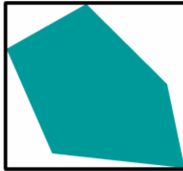
Şekil (3.5) 27 En küçük sınırlayıcı dikdörtgen
