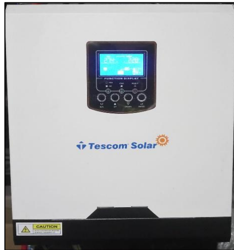
Şekil 4.6. PWM 3kW Tam Sinüs Akıllı Evirici
