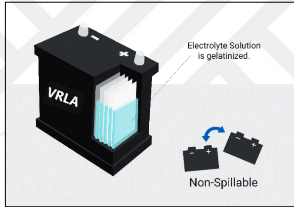
Şekil 3.7. Bataryanın iç yapısı(temsili)
