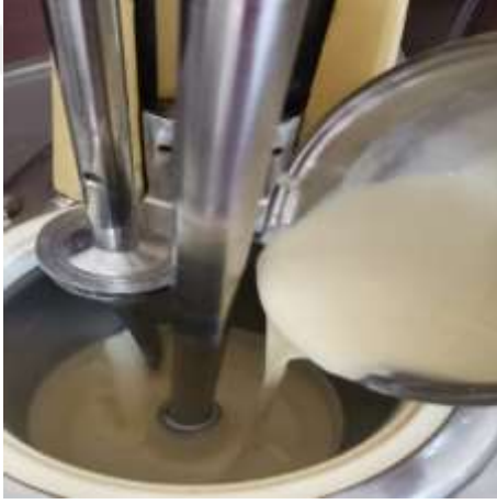
8. Miks süzgeçten geçirildikten sonra dondurma makinesine alınarak soğutma ve havalandırma işlemine tabi tutulur.
