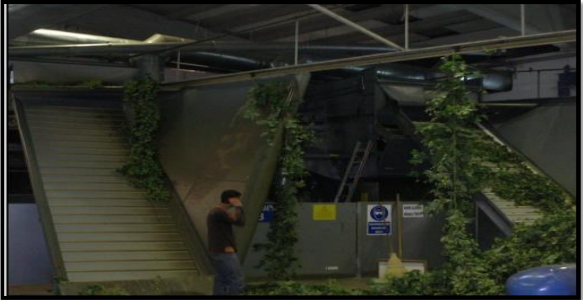
Fotoğraf 4.3. Hasat Edilmiş Şerbetçiotlarından Makinede Kozalaklarının Ayrılması
