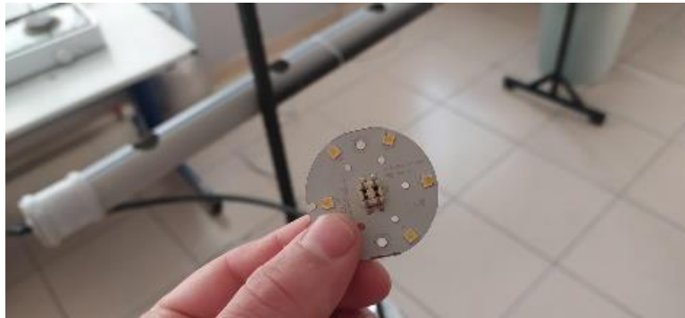
Şekil 6. Led ampul içinden sökülen led düzeneği
