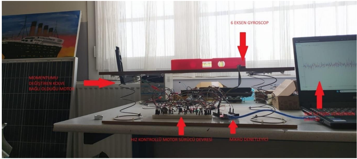
Şekil 22. Deprem Simülör yapısı ve dizaynı.
