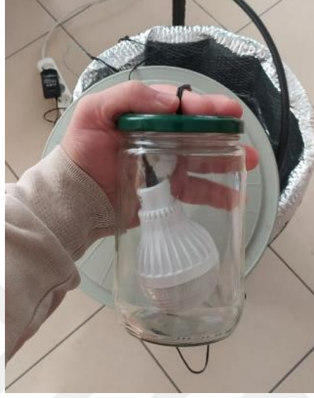
Şekil 7. İçindeki Ledleri UV ledlerle değiştirilmiş ampul
