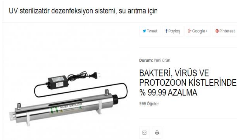
Şekil 5. Dakikada 8 galon (32 litre) arıtma yapabilen bir UV cihaz. ( https://alkalinsuaritma.com/diger-urunler/1449-uv-0001.html )
