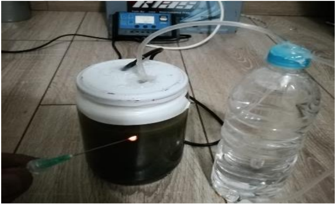
Şekil 61. Sudan elde edilen hidrojenin ine ucunda yakılması
