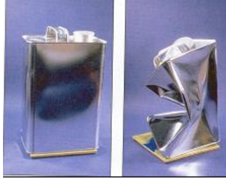
Şekil 1.8 Eğer içerisindeki tüm hava boşaltılırsa bir odadaki hava basıncı metal bir kutuyu çöktürür.
