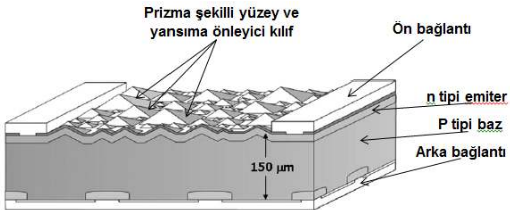
Şekil 2.12. Tek kristal yapıdaki silikon güneş pilinin yapısı [14].
