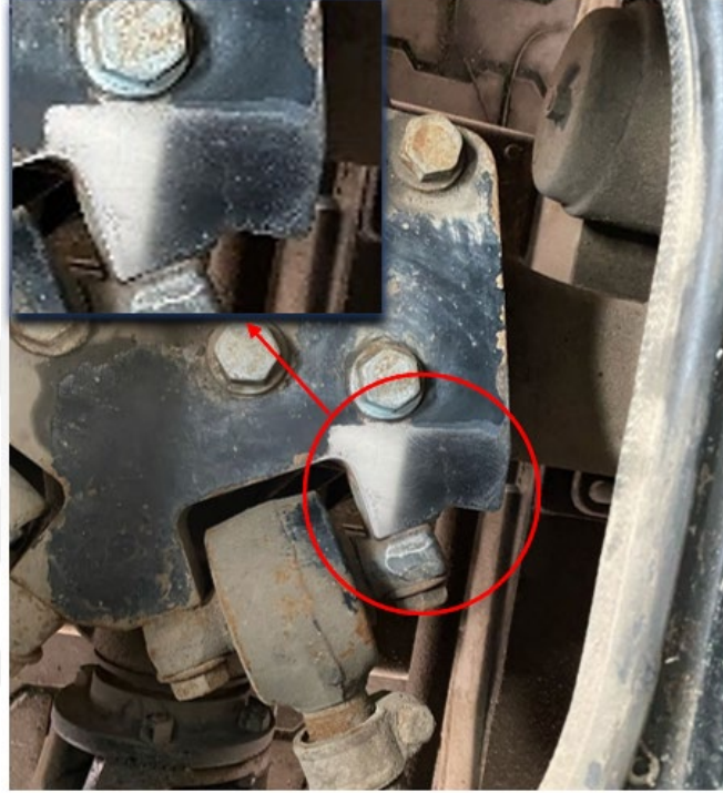
Şekil 4.5. Zımpara Yapılmış Yapıştırma Yüzeyi.
