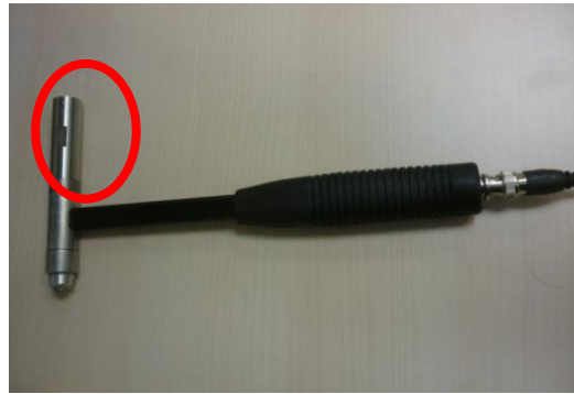
Şekil 4.8 : Motor bloğunun daha kolay tahrik edilebilmesi amacıyla kullanılan ekstra kütle .
