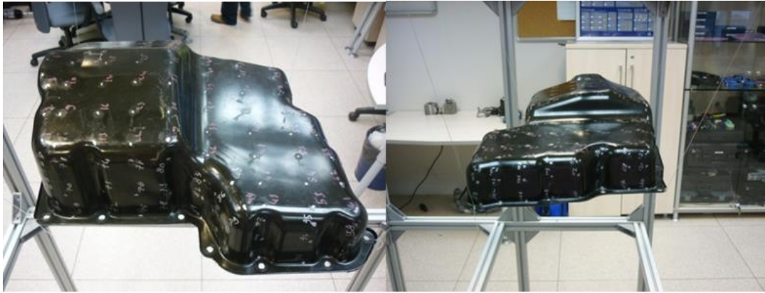
Şekil 4.20 : Modal test çalışması için yağ karteri üzerinde işaretlenen ölçüm noktaları.
