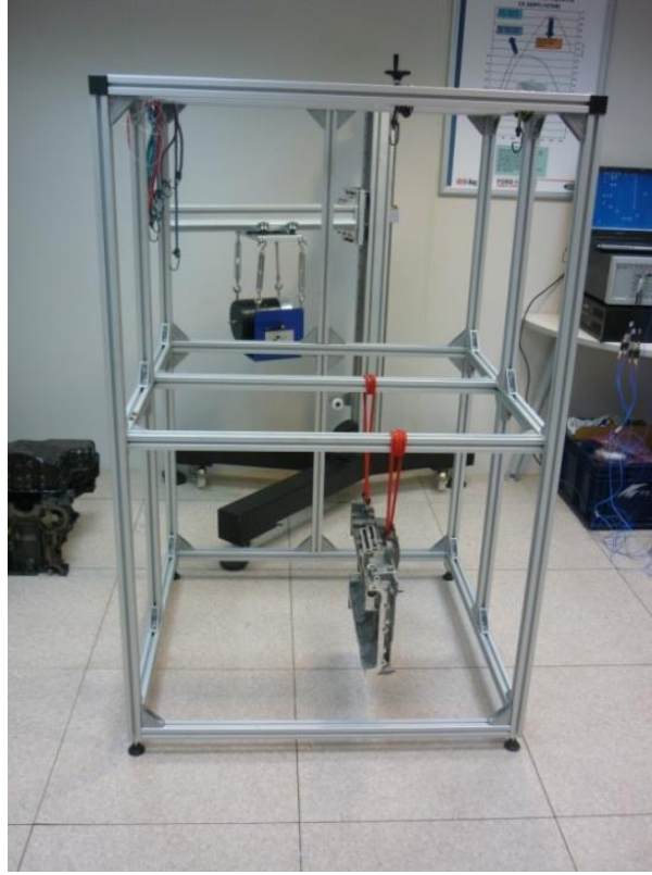
Şekil 4.15 : Ladder frame'in modal test gerçekleştirilmek üzere askı düzeneğine serbest-serbest koşullarda asılması.
