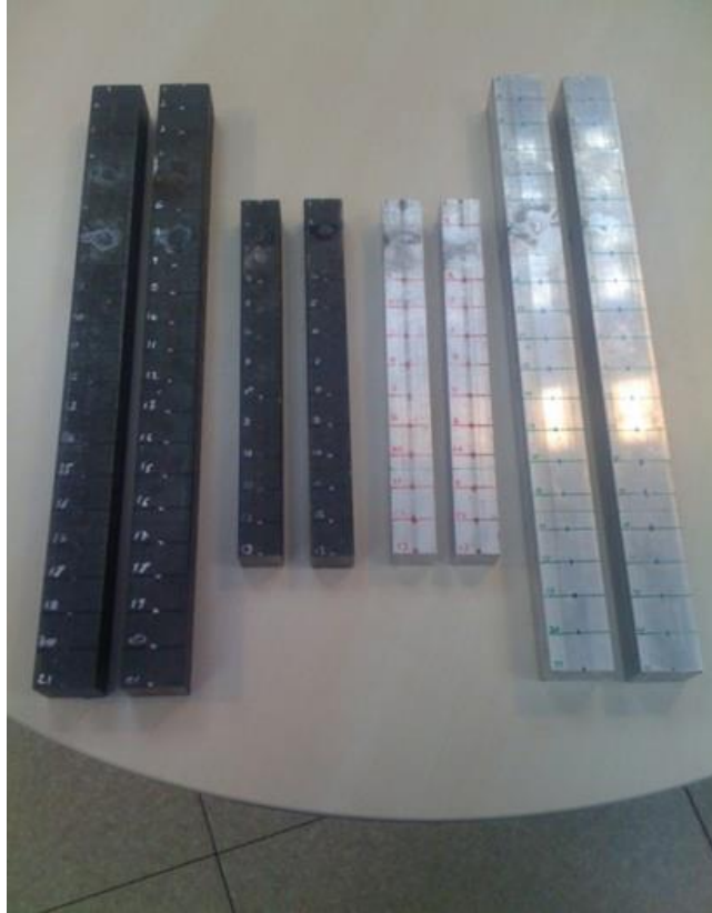
Şekil 3.3 : Malzeme sönüm testlerinde kullanılacak yeni numuneler.
