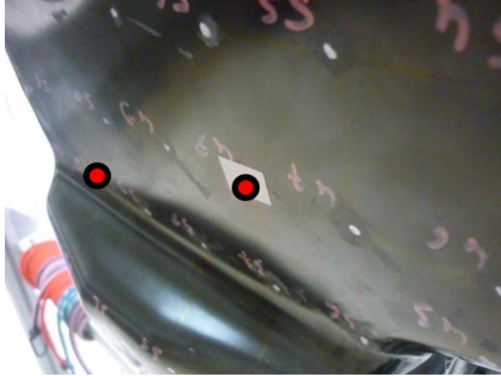
Şekil 4.54 : Sayısal analiz çalışmalarında kullanılacak malzeme sönümü değerlerinin hesaplandığı FTF'nin elde edildiği ölçüm noktaları.
