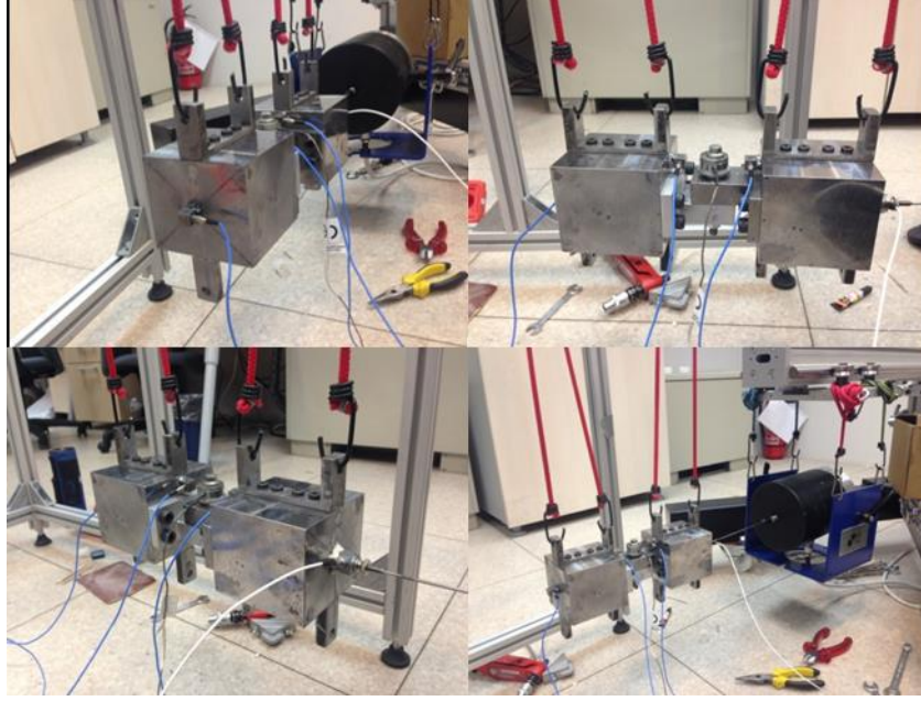
Şekil 5.6 : Kuru sürtünme test düzeneği üzerinde kullanılan sensör konumları.
