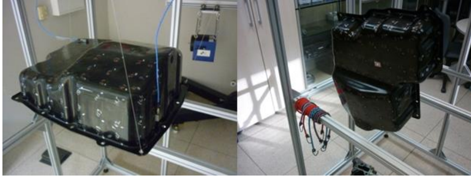
Şekil 4.32 : Sırasıyla doğal frekans & mod şekli elde etmek amacıyla yapılan ve malzeme sönümü elde etmek amacıyla yapılan modal testler sırasında yağ karteri'nin farklı asılış biçimleri.
