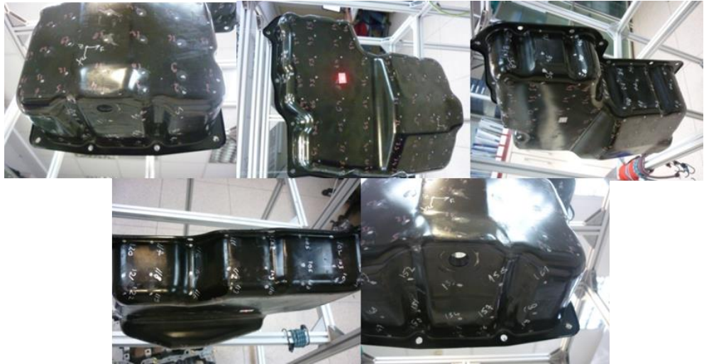
Şekil 4.36 : Ladder frame malzeme sönümü, modal test ölçüm noktaları sırasıyla 14, 40, 61, 70, 76, 106, 121, 160.
