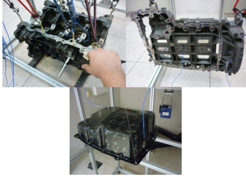
Şekil 4.1 : Bu bölümde deneysel ve sayısal çalışmalarda kullanılan motor parçaları, sırasıyla Motor bloğu – Ladder frame – Yağ karteri.
