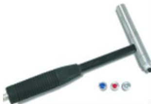
Şekil 3.7 : Modal test sırasında kullanılan modal çekiç ve ivmeölçer.
