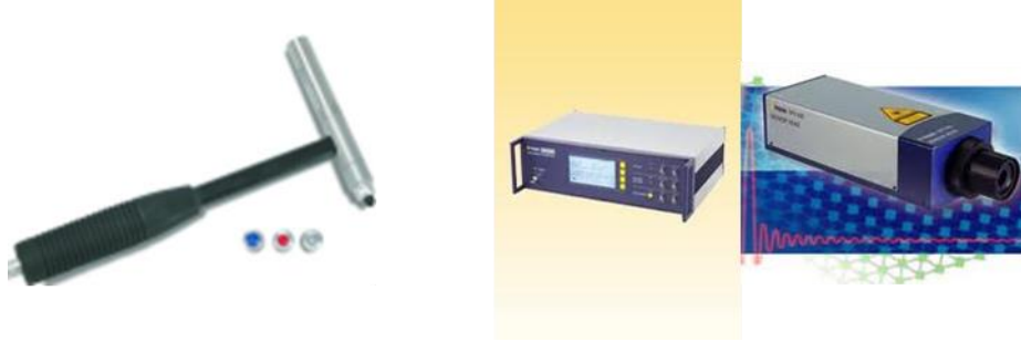
Şekil 3.8 : Modal test sırasında kullanılan modal çekiç ve lazer titreşimölçer.
