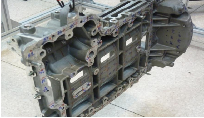
Şekil 4.12 : Modal test çalışması için ladder frame üzerinde işaretlenen ölçüm noktaları.
