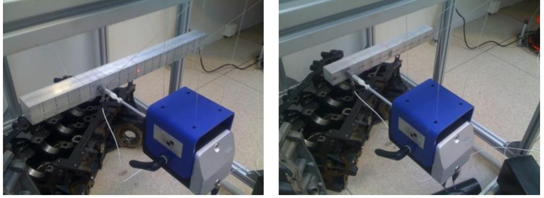
Şekil 3.11 : Alüminyum malzeme, 40x40x500mm ve 30x30x300mm numunelerin modal sarsıcı ile sarsılması.
