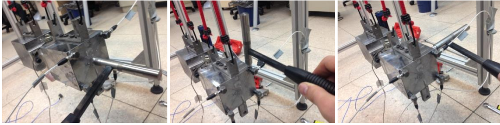
Şekil 5.9 : Modal test çalışmasındaki tahrik noktaları.
