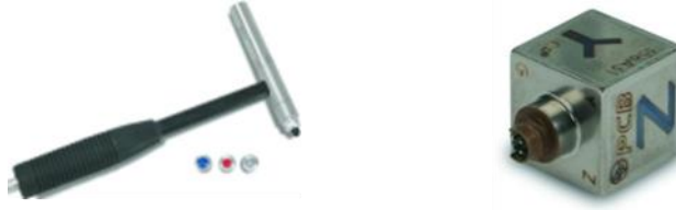
Şekil 4.2 : Doğal frekans ve mod şekli elde etmek için yapılan modal test çalışmaları sırasında kullanılan modal çekiç ve ivmeölçer.
