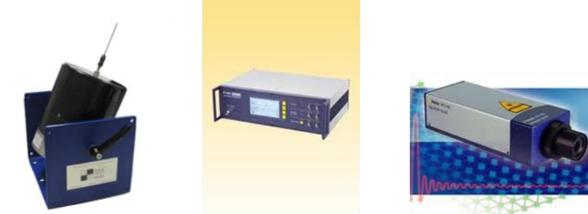
Şekil 3.9 : Modal test sırasında kullanılan modal sarsıcı ve lazer titreřimölçer.
