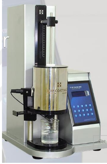
Resim 3.6 İnfrared kurutma hazneli daldırma kaplama cihazı (İnt. Kyn. 14).
