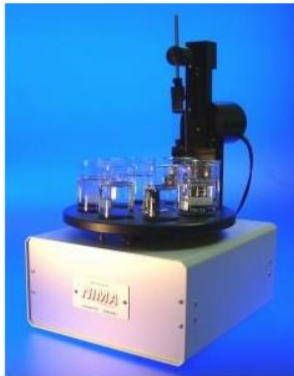
Resim 3.7 Çoklu daldırma özellikli daldırma kaplama cihazı (İnt. Kyn. 15).
