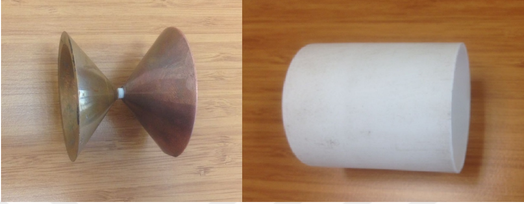
Şekil 7.1. Üretilen çift konik anten ve radom
