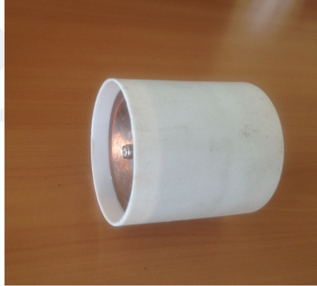
Şekil 7.2. Üretilen çift konik anten ve radomun entegre yapısı
