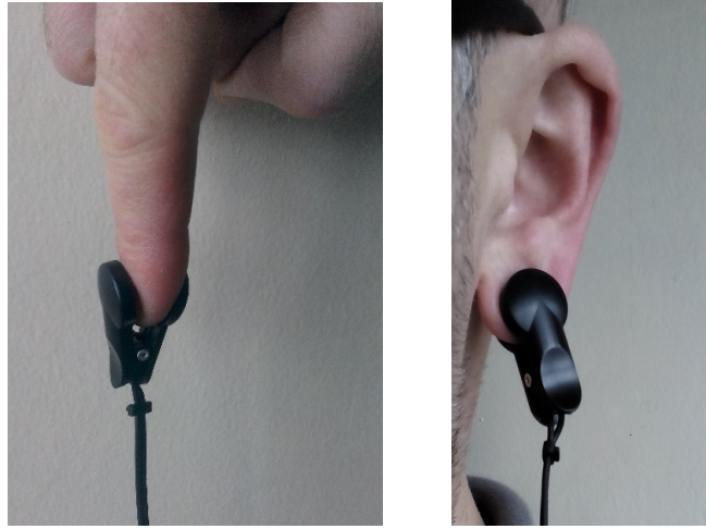
Şekil 4.6. Nabız sensörünün parmak ve kulağa takılışı.
