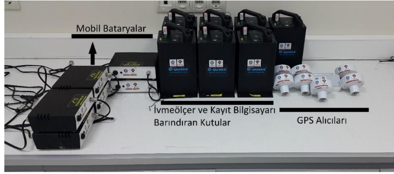
Şekil 3.30. E-Quake İvmeölçerler ve Modülleri (Anonim, 2019)
