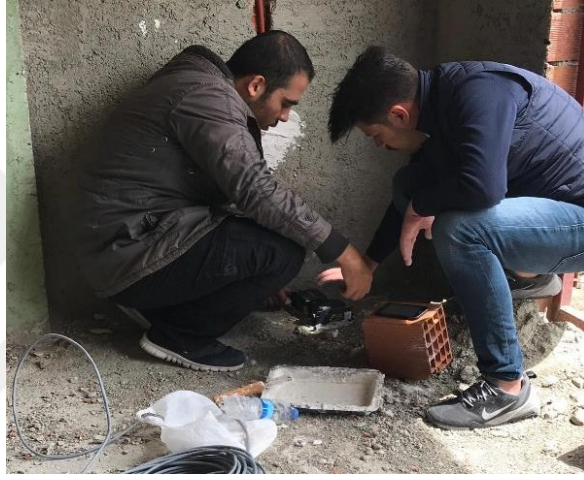
Şekil 3.47. Kablolu Ölçüm Sistemine Ait Cihazların Sabitlenmesi
