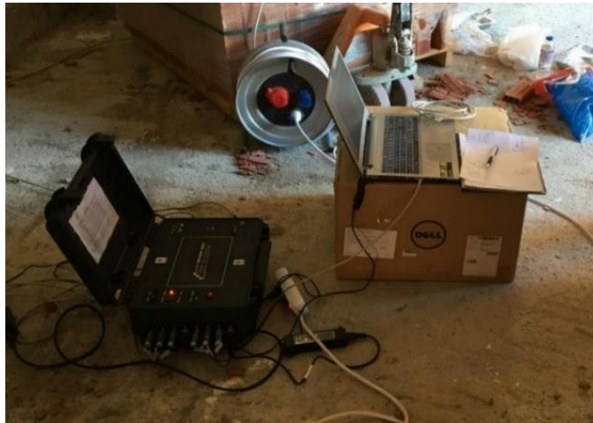
Şekil 3.48. İvmeölçerlerin Kablo Bağlantılarının Yapılması ve Sisteme Tanıtılması
