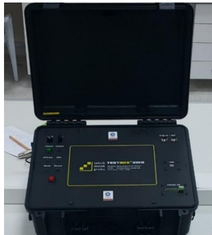
Şekil 3.36. TESTBOX2010 Dinamik Veri Toplama / Yapısal Sağlık Takibi Cihazı
