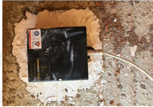
Şekil 3.42. İvmeölçerlerin Binada Belirlenen Noktalara Sabitlenmesi
