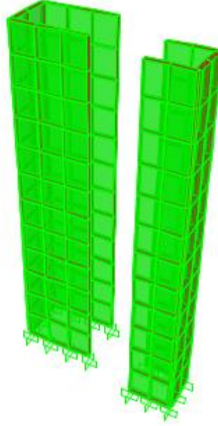
Şekil 3.15. Perdelerin Alan Eleman Yöntemi İle Sisteme Girilmesi
