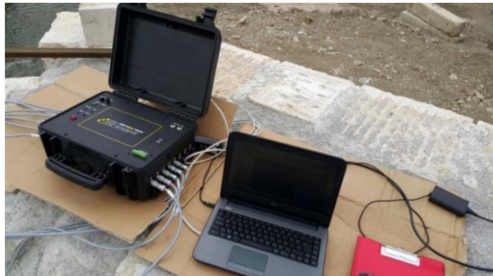
Şekil 3.35. 16 Kanallı Taşınabilir Dinamik Veri Toplama Sistemi (Anonim, 2019)
