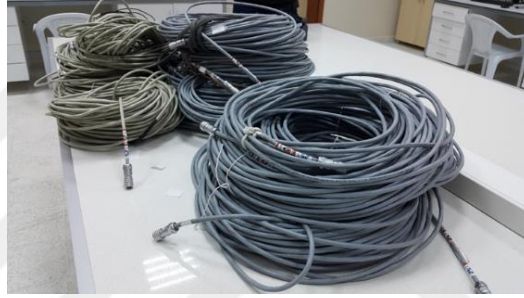
Şekil 3.32. İvmeölçerlerin Veri Toplama Sistemine Bağlantı Kablosu
