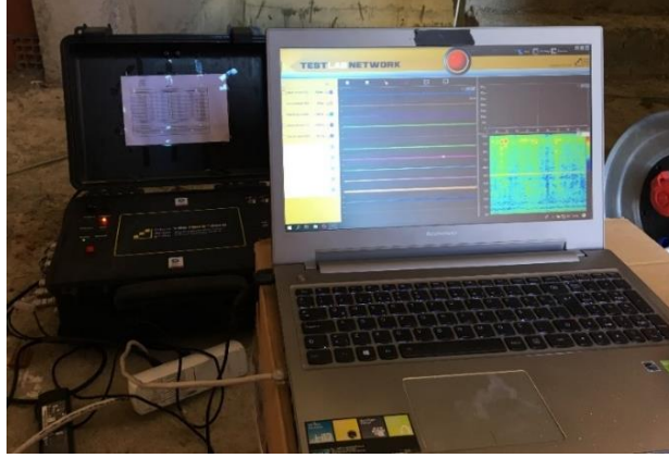
Şekil 3.51. Kablolü Ölçümde Kurulan Veri Toplama Ünitesi
