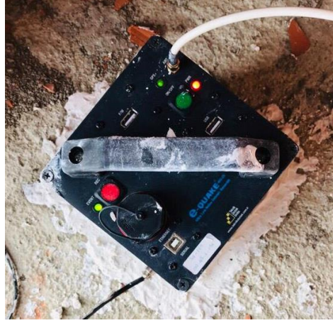
Şekil 3.41. E-Quake Cihazlarının Binada Belirlenen Noktalara Sabitlenmesi
