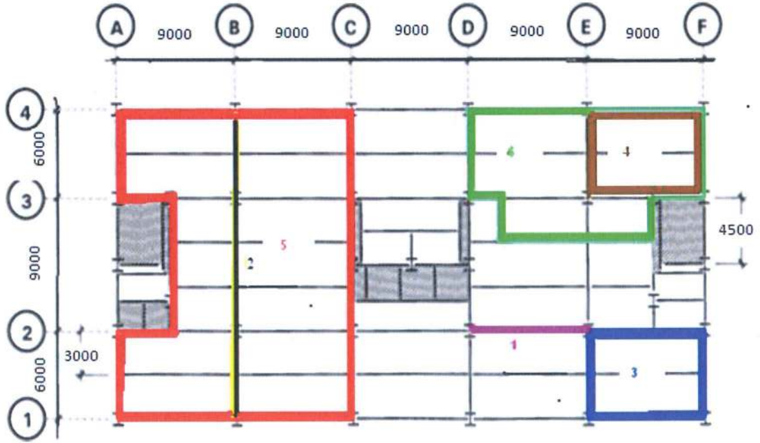
Şekil 3.11 Yangın testlerinin yerleşim planı ve mevkileri
