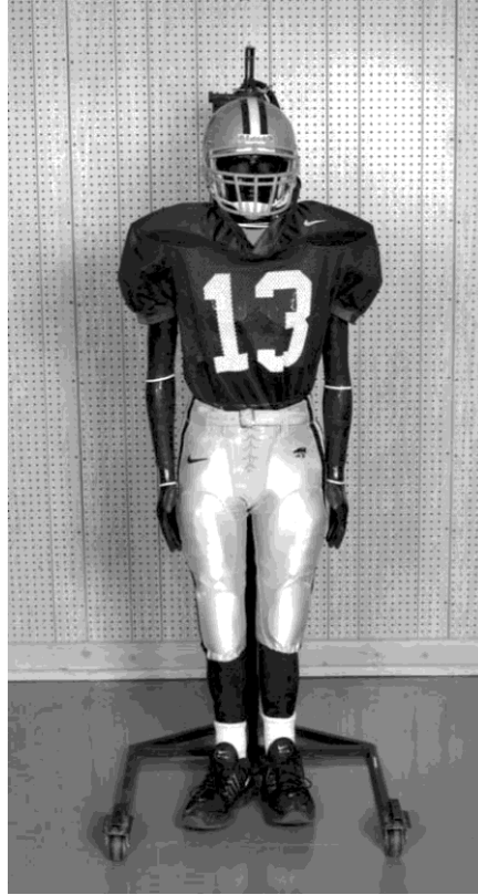
Şekil 2.1 Kansas Eyaleti Üniversitesinde geliştirilen ısı manken (Coullogh,E.2005)
