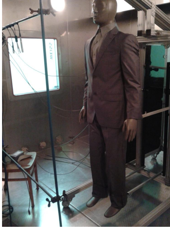
Şekil 4.5 Isıl manken Newton ile giysi takımı denemelerinden bir görünüm
