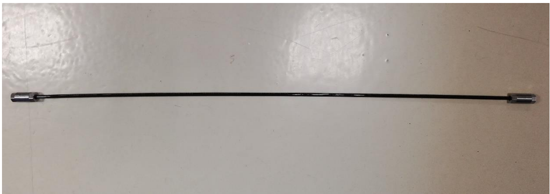
Şekil 4.17. Malzeme çözünmesine karşı direnç testi için hazırlanan örnek bir numune görüntüsü
