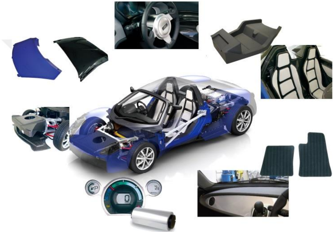
Şekil 3.1. Otomotiv endüstrisinde kullanılan kompozit malzeme örnekleri [37]
