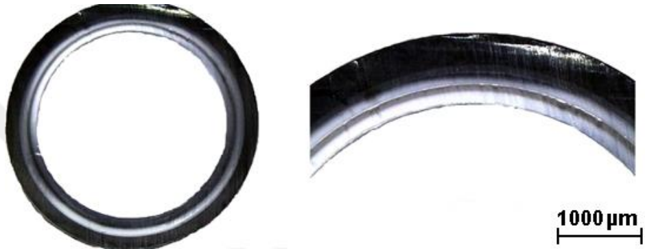
Şekil 4.4. 5 katlı PA boruya ait optik mikroskop görüntüsü
