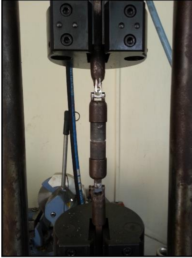
Şekil 5.14 : Yapışma mukavemeti testinin yapıldığı çekme cihazı ve standarda göre hazırlanmış sistem.
