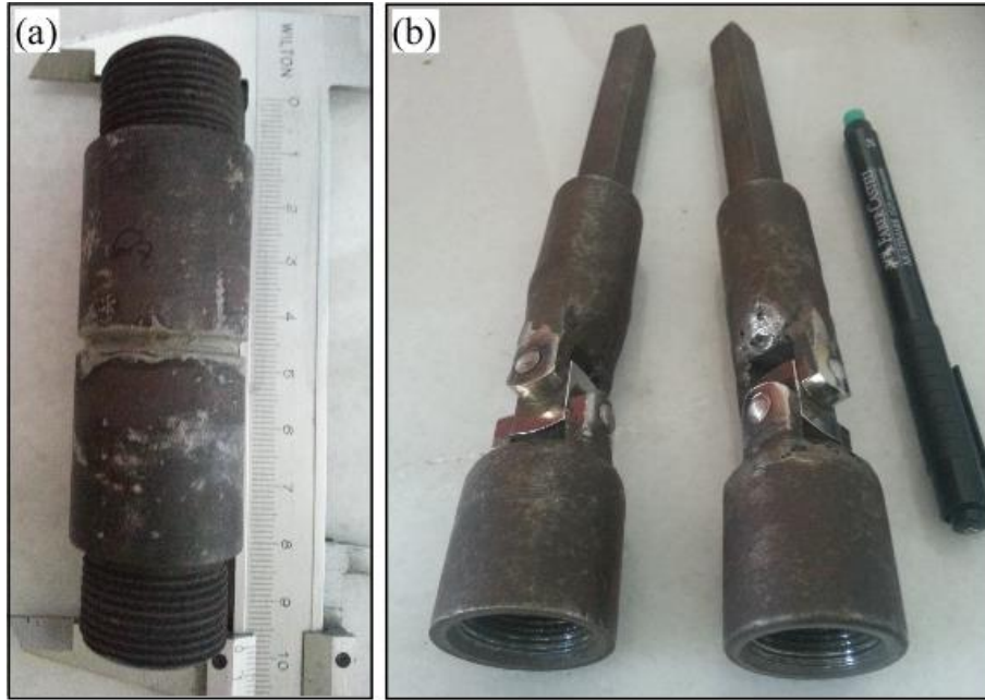
Şekil 5.13 : (a) yapıştırılma ve kürleme sonrası numune tutucu aparat, (b) çift mafsallı çekme aparatı.
