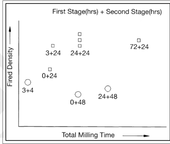
Şekil 2.29 Sinterlenmiş ürün yoğunluğunun öğütme süresine bağlı değişimi (Mistler and Twinn 2000).
