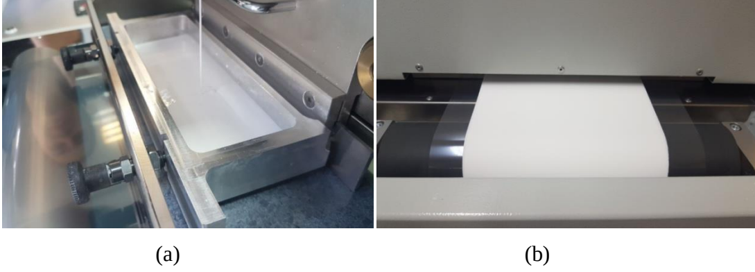
Şekil 3.6 Şerit döküm ünitesinde a) döküm haznesi, doctor blade b) üretilen şerit örneği.
