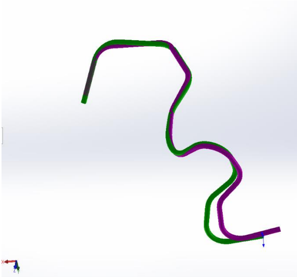
Şekil 4.2. Analiz sonucuna göre elde edilen datanın fırın prosesi sonrası taranan data ile karşılaştırılması-1
