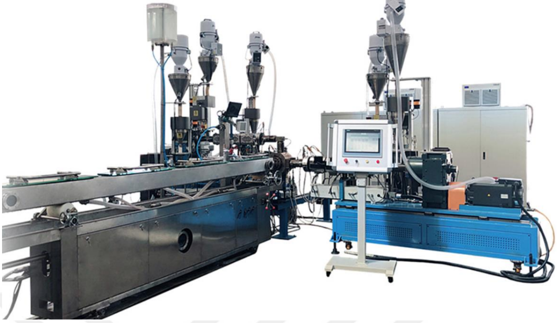
Şekil 2.14. Ekstrüzyon hattı örneği (Anonim6, 2022)
