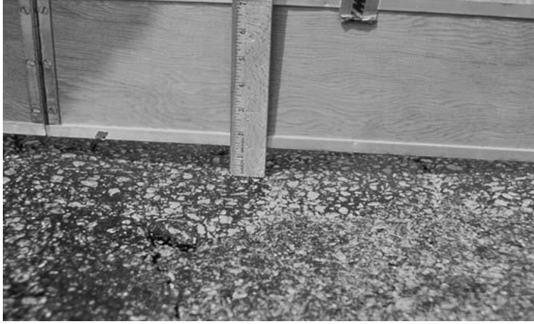
Şekil 2.28. Yüksek şiddetli Tekerlek izinde oturma bozulması (ASTM D6433-11 2011)
