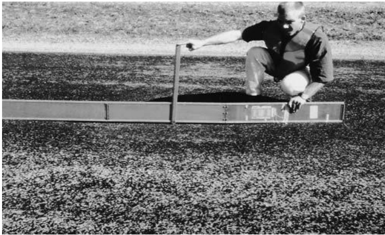
Şekil 2.17. Hafif şiddetli lokal oturma bozulması (ASTM D6433-11 2011)
