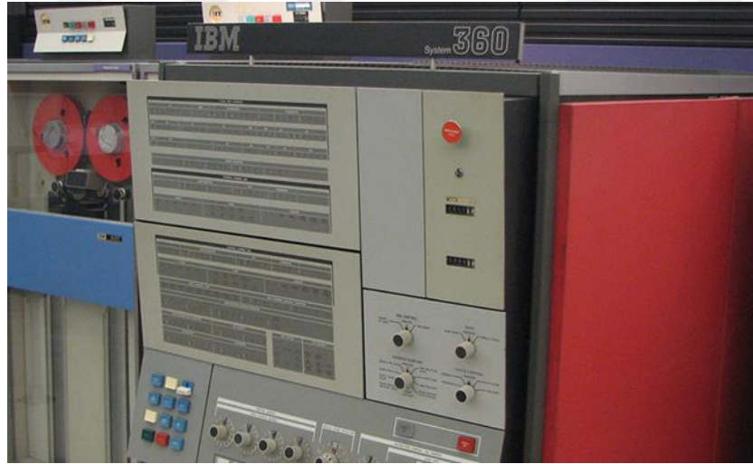
Şekil 2.7. IBM anaçatı bilgisayarlı birinci nesil SCADA [44].
