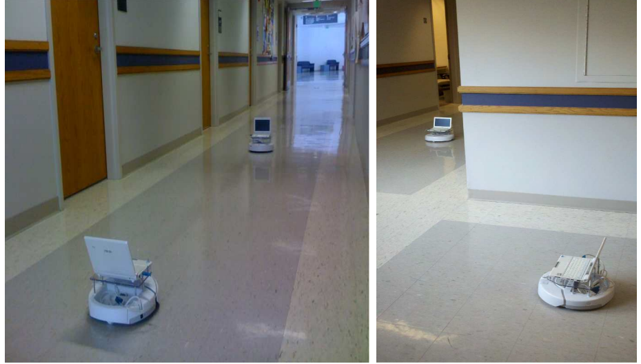
Şekil 4.8: SOL: Üzerlerinde Asus EEE PC laptop olan, düz bir koridor üzerine yerleştirilmiş olan iki iRobot Create robotunu gösteren birinci ve ikinci deneyin kurulumu. SAĞ: Üzerlerinde Asus EEE PC laptop olan, dikdörtgen şeklinde bir koridor üzerine yerleştirilmiş olan iki iRobot Create robotunu gösteren üçüncü grup için olan deney kurulumu.
