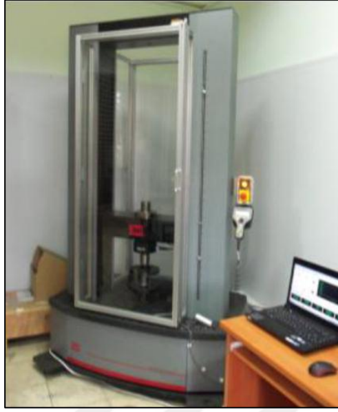
Şekil 6. MTS Criterion 45 serisi universal test sistemi
