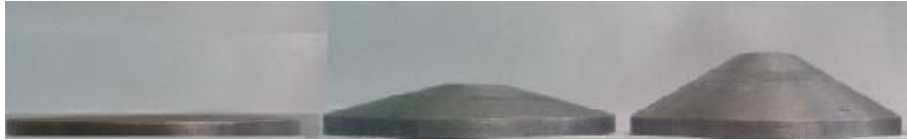
Şekil 10. Alt kalıp açılarının görünümü ( 0^\circ , 15^\circ , 30^\circ )
