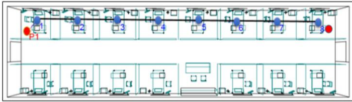
Şekil 5.2. Tek koridorlu plan tipinde kaynak-alıcı noktaları
