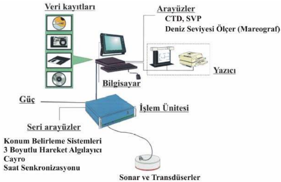
Şekil 2.6. Çok yönlü sonar ile derinlik ölçümü donanımı (Simrad Kullanma Klavuzu [2])
