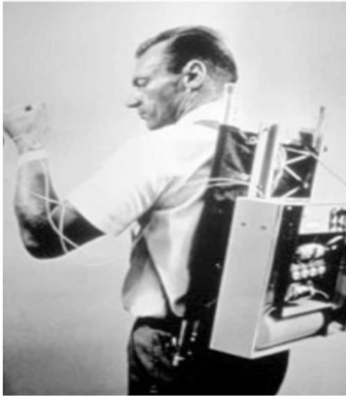
Şekil 1. Arnold Kadish tarafından 1970'li yıllarda tasarlanan ilk insülin infüzyon pompası
