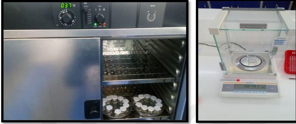
Resim 13: 37 °C de etüv ve hassas terazi
