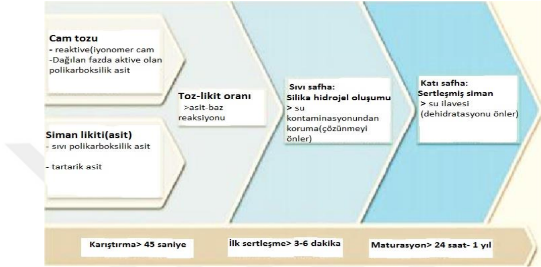
Şekil 9: Cam iyonomer simanın maturasyonunda görülen başlıca sertleşme safhaları
