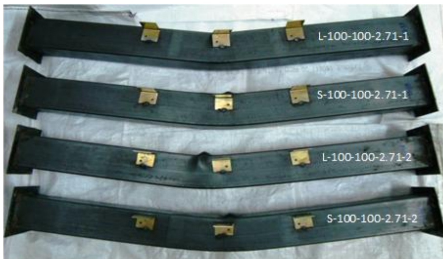
(b) 100×100×2.71 mm CFST beams
