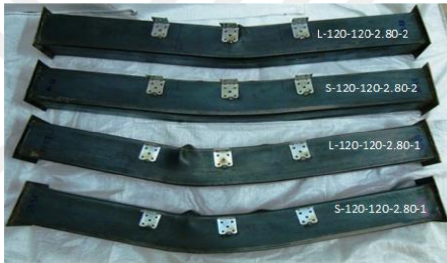
(d) 120×120×2.80 mm CFST beams
