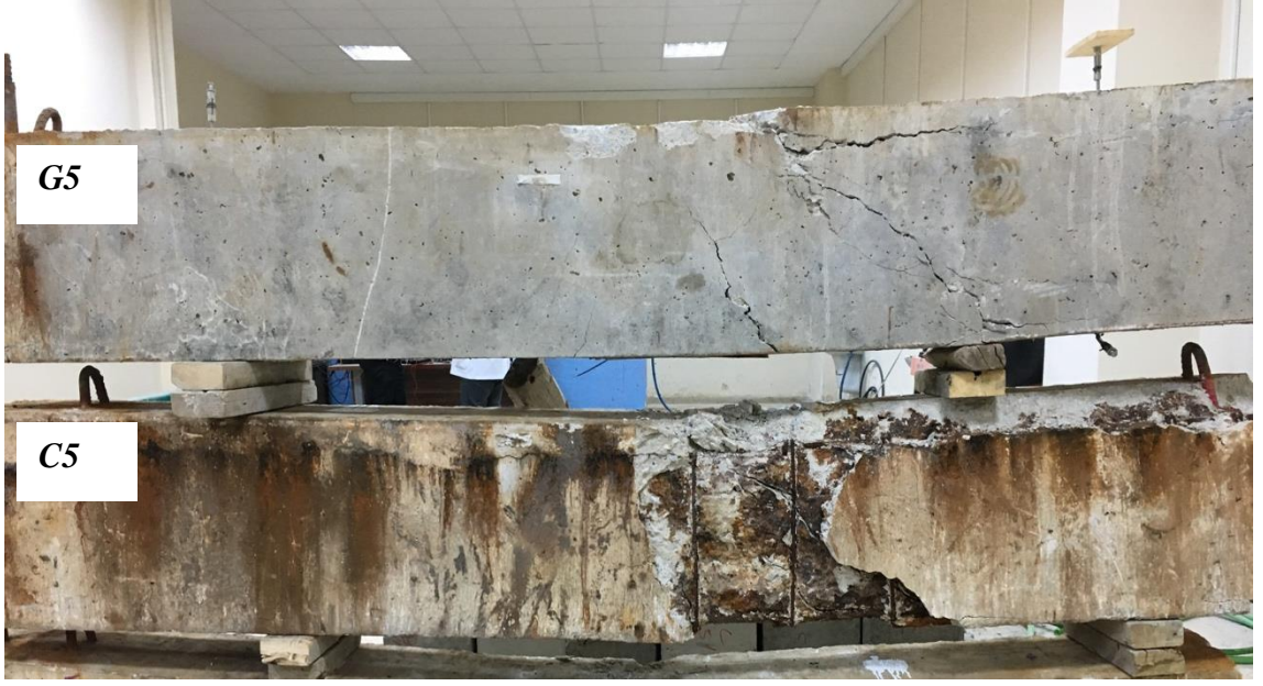
Şekil 5.21. G5 ve C5 Kırım Sonrası Çatlak Desenleri
