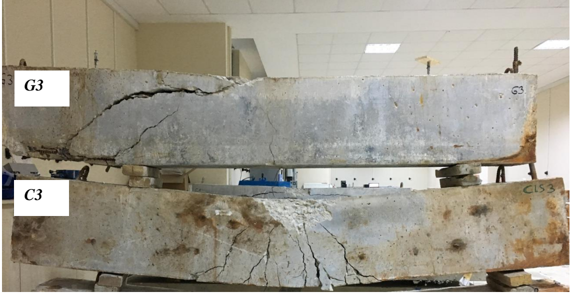
Şekil 5.17. G3 ve C3 Kırım Sonrası Çatlak Desenleri
