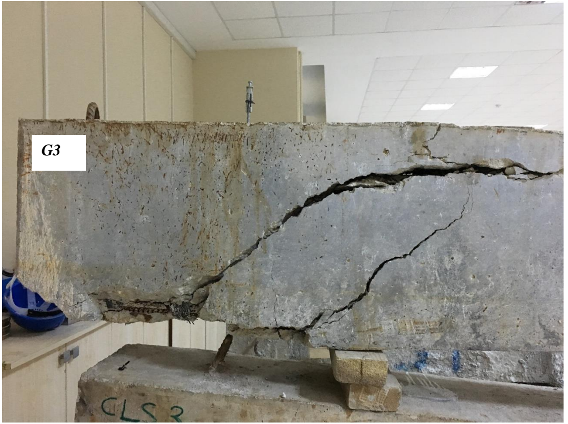
Şekil 5.18. G3 Detaylı Çatlak Desenleri
