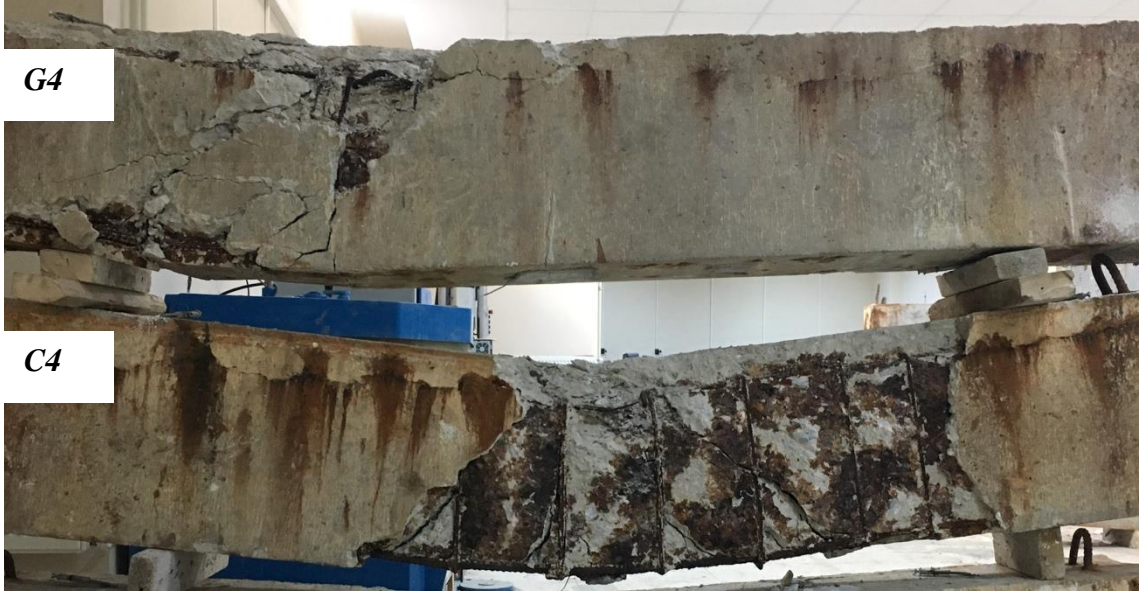
Şekil 5.19. G4 ve C4 Kırım Sonrası Çatlak Desenleri
