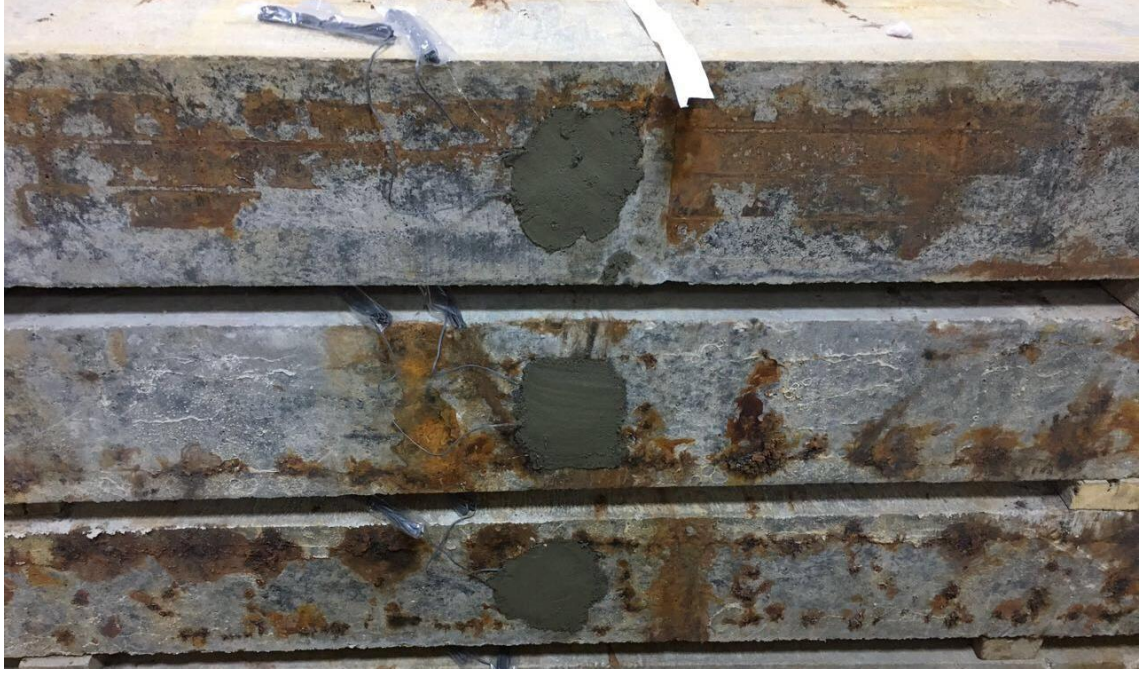
Şekil 4.15. Yerleştirilen Gerinim Ölçerlerin Tamir Harcı İle Kapatılması
