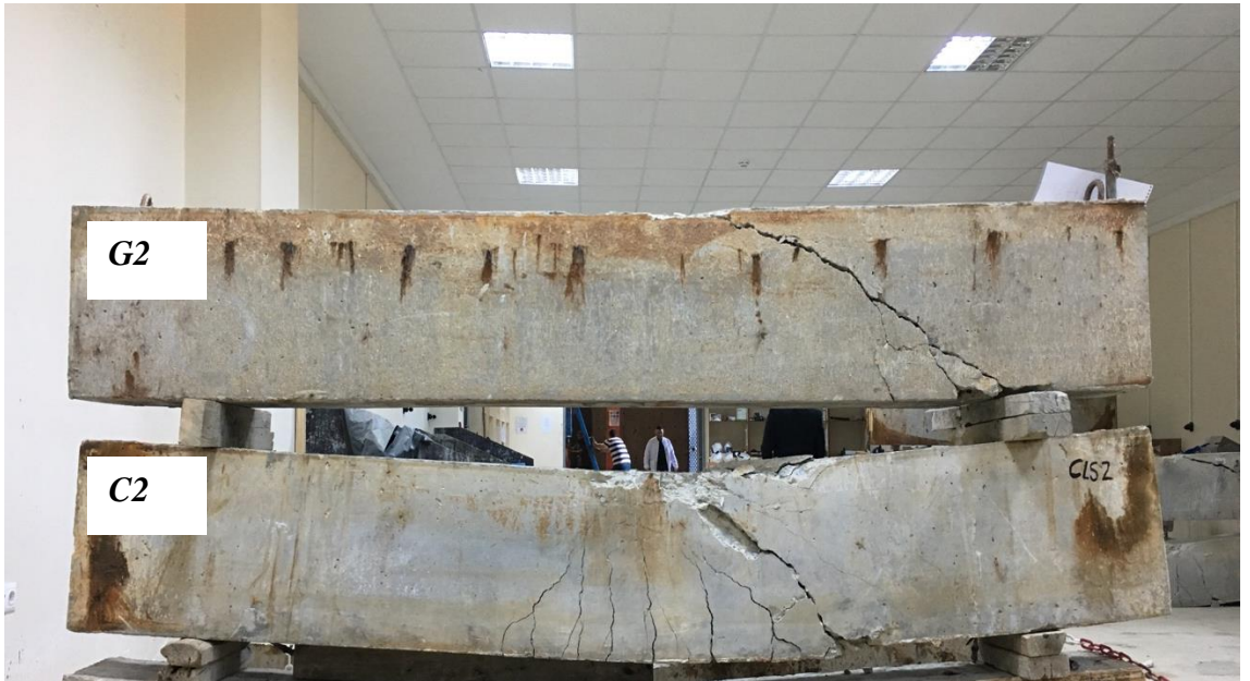
Şekil 5.16. G2 ve C2 Kırım Sonrası Çatlak Desenleri
