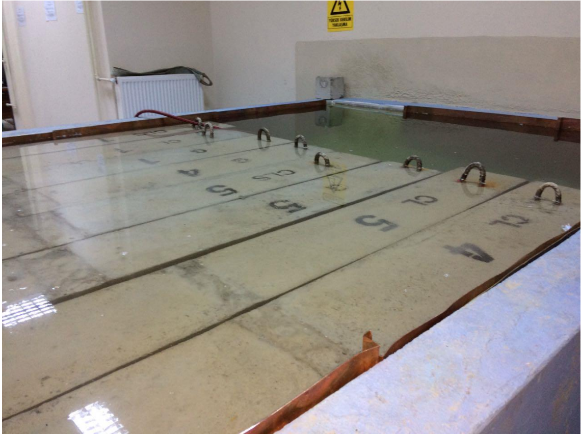
Şekil 4.12. Betonarme Kirişlerinin Kürlenmesi
