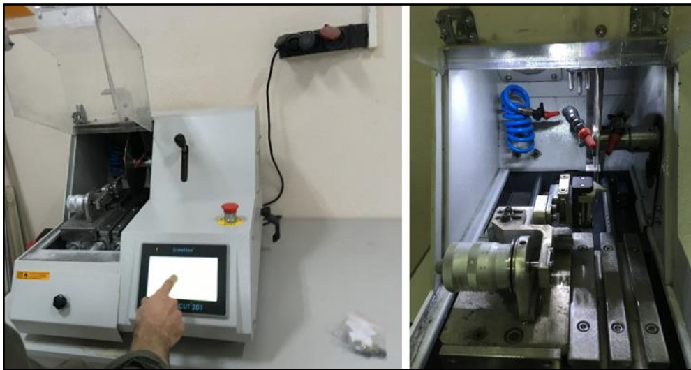
Şekil 3.5: Numunelerin kesilmesinde kullanılan hassas kesme cihazı
