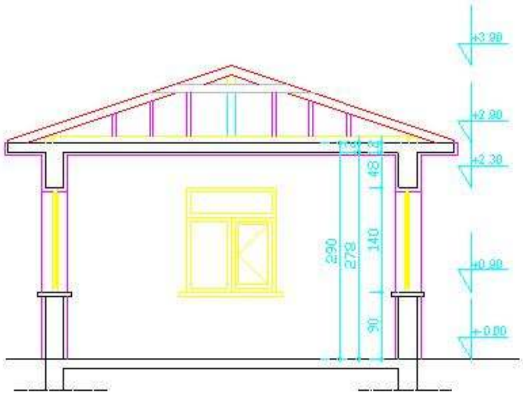
Şekil 2.3 Kantar Binası Kesiti
