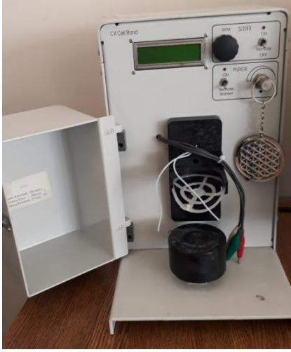
Şekil 2.2. Elektrokimyasal hücrenin yerleştirildiği, manyetik karıştırma ve inert gaz ile süpürme standı (C4 hücre standı)
