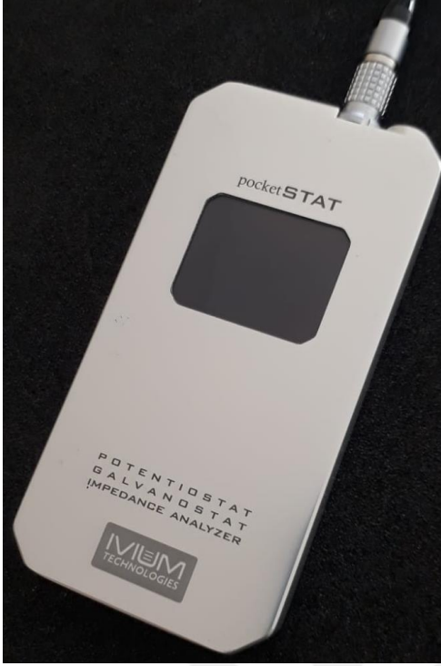
Şekil 2.1. Ivium pocketSTAT potansiyostat/galvanostat empedans analizörü
