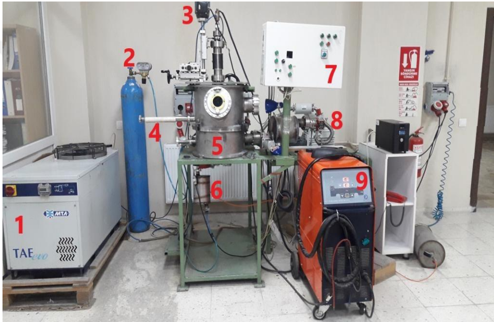
Şekil 3. 3 Vakum ark ocağı ünitesi (1; Soğutma ünitesi, 2; Argon gazı, 3; X ve Y eksenlerinde hareketi sağlayan körük, 4; Manipülatör kol, 5; Ark ocağı haznesi, 6; Pnömomatik emiş vanası, 7; Kontrol panosu, 8; Rotary vakum pompası ve turbo moleküler pompa, 9; Ark güç kaynağı).
