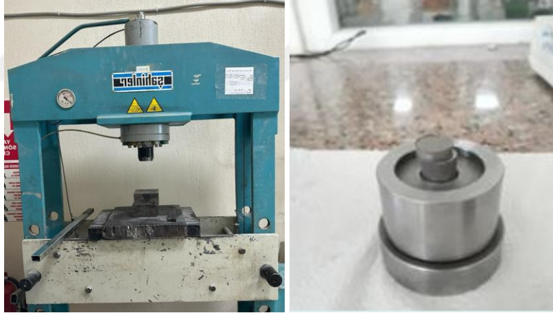
Şekil 3. 2 Pres makinası, çelik toz basma kalıbı ve şekillendirilen tablet.
