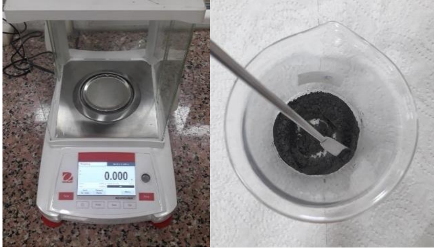
Şekil 3. 1 Hassas terazi yardımı ile 100 gr. tartılan toz karışımı.
