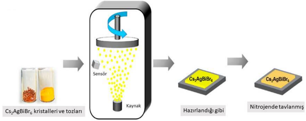
Şekil 2. 8. Cs 2 AgBiBr 6 partikülleri kullanılarak gerçekleştirilen ısı buharlaştırma çalışmasının şematik gösterimi (Fan ve ark., 2019)
