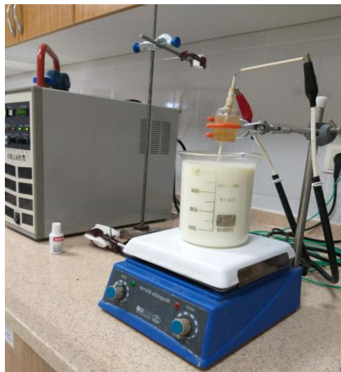
Şekil 3.1 Çözelti plazma tekniğinin çiğ süte uygulama esnasında sistemin fotoğrafı.
