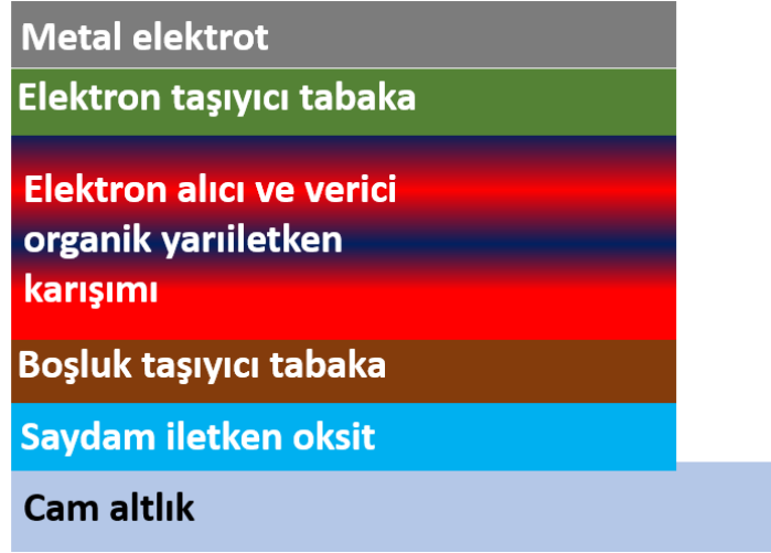
Şekil 2.6. Organik güneş hücrelerinin şematik gösterimi
