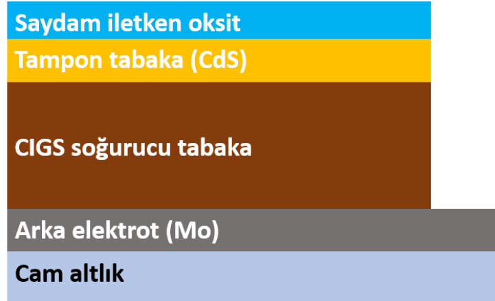
Şekil 2.5. CIGS esaslı hücrenin şematik gösterimi
