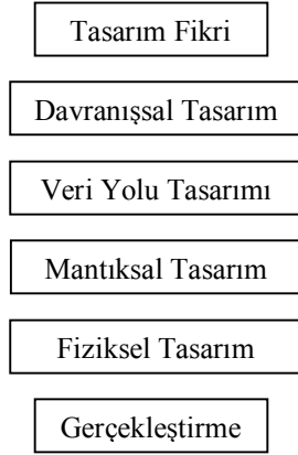
Şekil 4.2. Sayısal sistem tasarımının aşamaları
