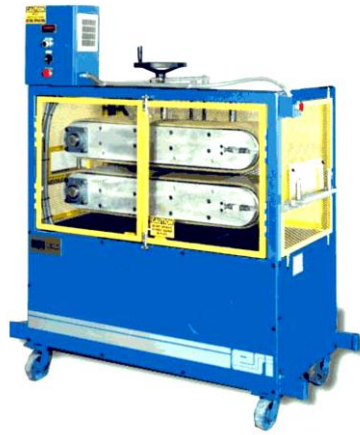
Şekil 5.13. PVC boru üretim hattındaki boru çekim makinesi [43]
