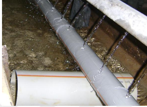
Şekil 6.10. Ekstrüzyon makinesi soğutma bölümü ve atık ile üretilen boru
