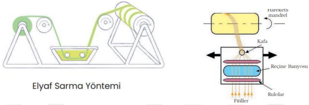
Şekil 2.17. Kompozit Malzeme Üretimi Elyaf Sarma (CTP Teknolojisi, 2018)
