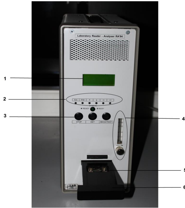
Şekil 5.3 Celal Bayar Üniversitesi Lüminesans Araştırma Laboratuvarında bulunan RA94 TLD Reader-Analyser sistemi
