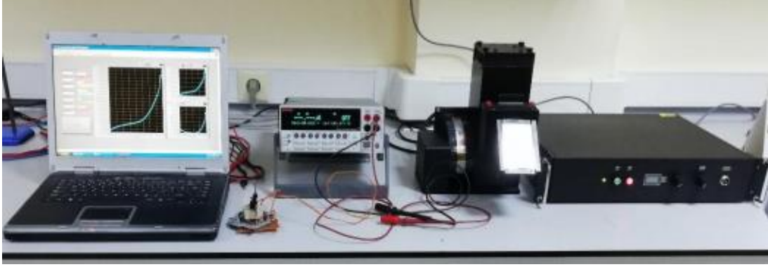
Şekil 26. Akım-voltaj karakteristiklerinin ölçüldüğü düzenek
