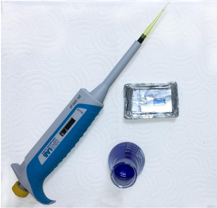
Şekil 16. Cam altlık üzerinde öncül katman kaplama işlemi
