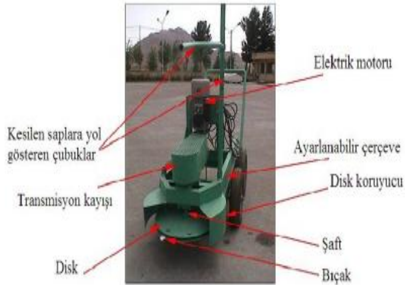
Şekil 1.33. İran'da geliştirilmiş tatlı sorgum hasat makinası (Ghahraei ve ark., 2008)
